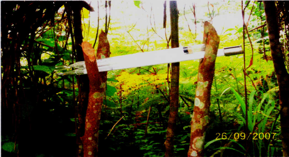
Figure 8 : Disposition des thermomètres sous abri (source : photo LITUCHA).
