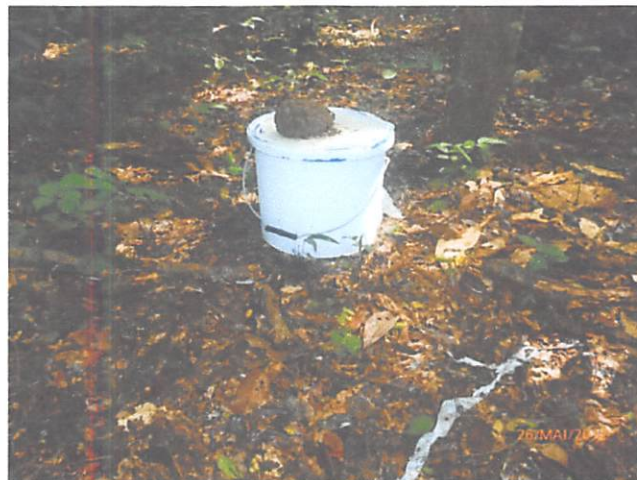
Fig. 13 : Mesures à vide (témoins) du flux de \text{CO}_2 .
